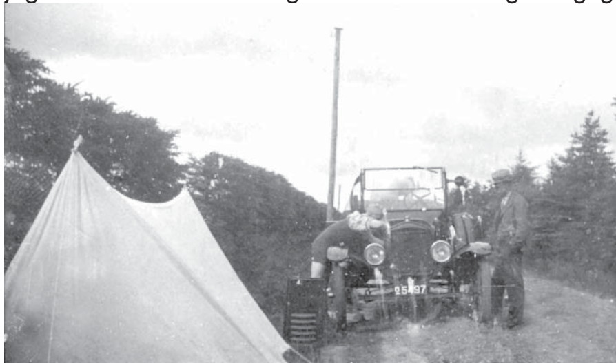
1930. Top- og bundstykke under afmontering for at tage stempel og plejlstang ud. Derefter kørtes der på 3 cylindre fra Oksbøl.
